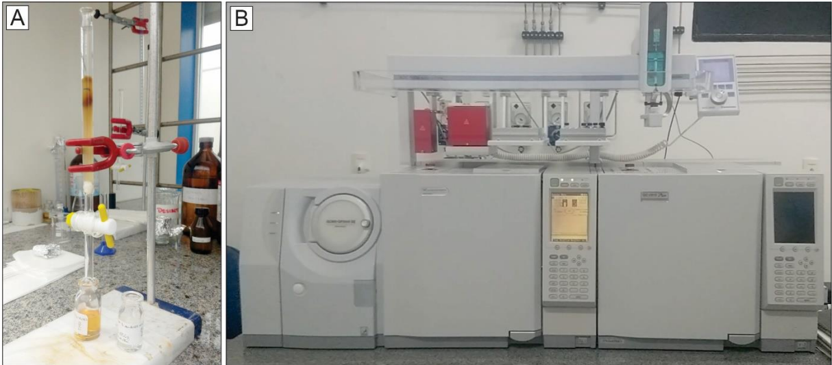
Figura 4.2. Análises de biomarcadores. Em (A) imagem mostra o processo de separação das frações em uma coluna cromatográfica com a fração P1 sendo coletada no frasco de vidro. Em (B) cromatógrafo da Shimadzu, modelo GCMS-QP2010 SE, equipado com auto injetor AOC-5000.
