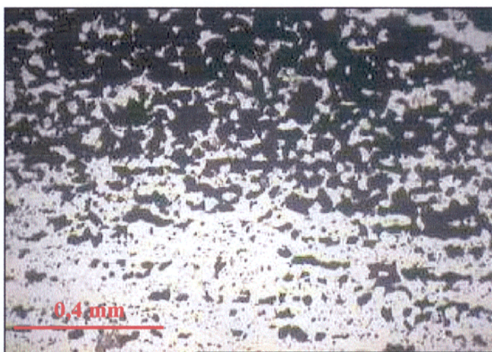
Figura 12 – Fotomicrografia de FFB tipo óxido, ressaltando a alternância de bandas quartzosas e bandas constituídas por fases opacas (Luz natural).
