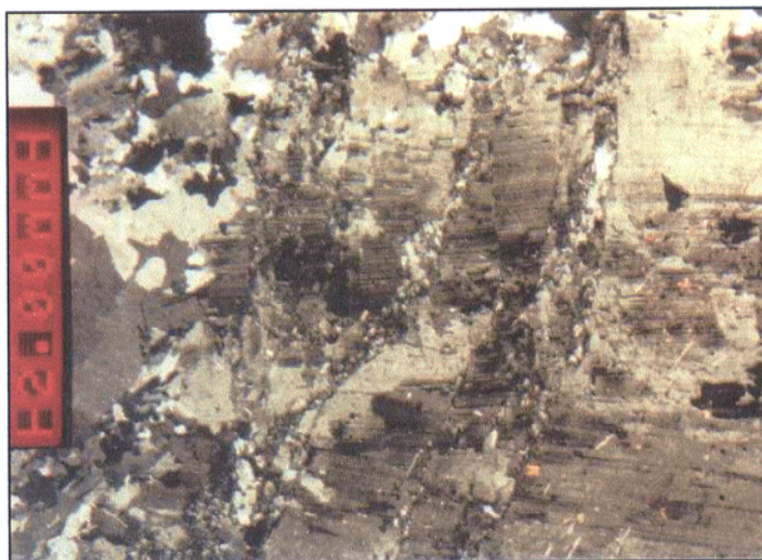
Figura 17 – Fotomicrografia ressaltando fenocristal de plagioclásio com deformação intracristalina (Nicóis cruzados).
