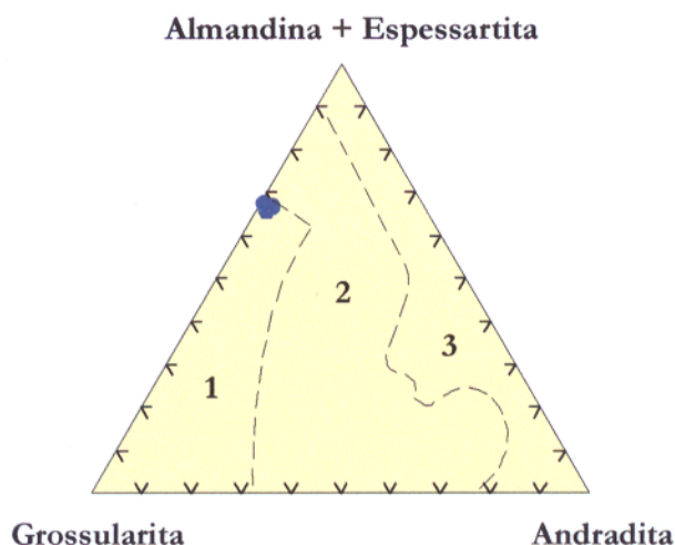
Figura 51 – Campos de escarnitos fortemente reduzidos (1), moderadamente reduzidos (2) e oxidados (3) definidos pela composição da granada (segundo Newberry 1983). Os círculos em azul representam a composição da granada do escarnito Amapari.
