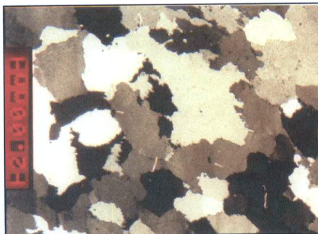
Figura 16 – Fotomicrografia mostrando bolsão de quartzo com contatos suturados entre si (Nicóis cruzados).
