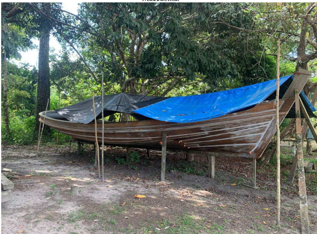
Figura 86 — A outra embarcação, também em itaúba, sendo construída pelo irmão Juca, na comunidade Macedônia.
