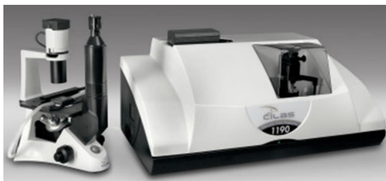
Figura 14- Equipamentos utilizados nas análises granulométricas dos sedimentos.
