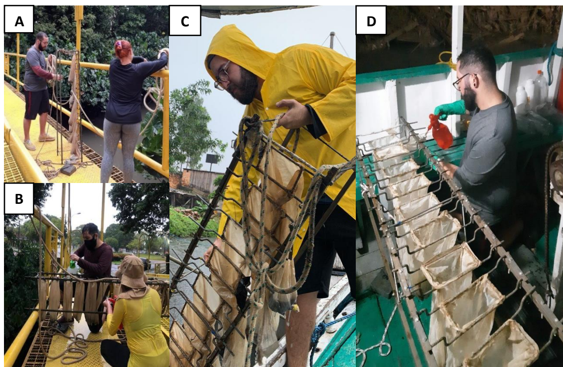
Figura 6 - A e B mostram a aplicação da armadilha de sedimentos Traps no rio Tucunduba, onde A é o momento de posicionamento da armadilha e B a retirada do MPS retido nas redes. C e D mostram a utilização da armadilha no rio Tamandaré, onde C mostra a retirada das redes com MPS retido e D a preparação para recolocada da armadilha.
