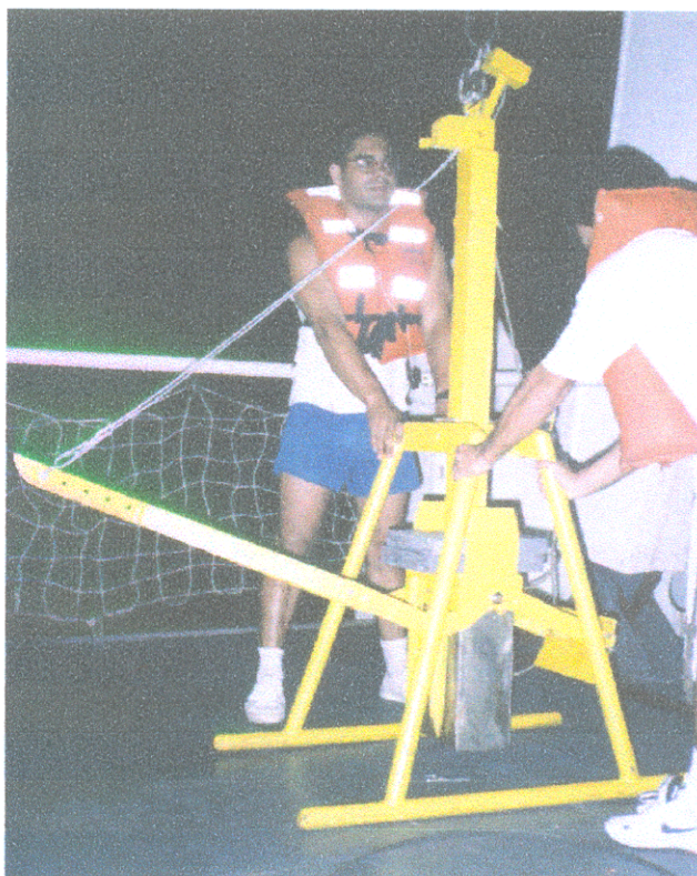
Figura 4.4: "Box Corer" utilizado para coleta dos sedimentos.
