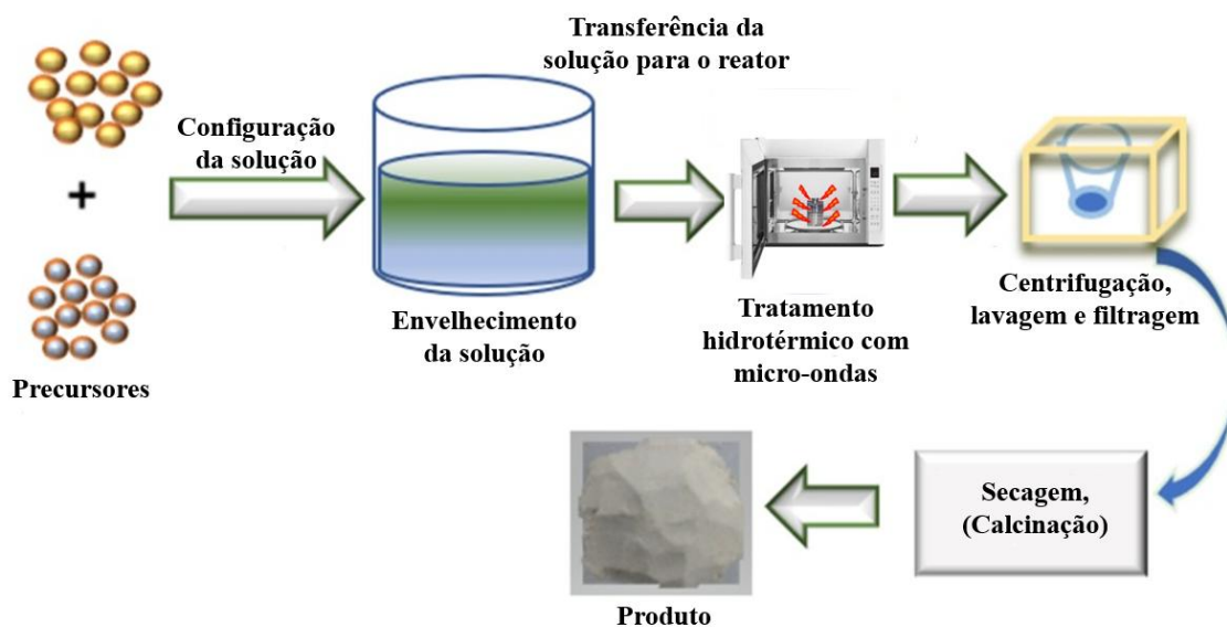
Figura 2.48 – Etapas gerais do método hidrotérmico com micro-ondas. Fonte: Autoria própria
