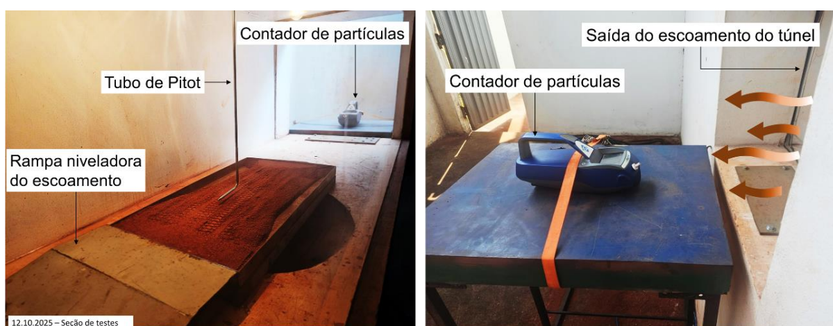
Figura 4.23 - Tubo de Pitot e contador de partículas instalados na seção de testes do túnel de vento.
