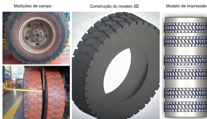
Figura 4.13 - Esquema de construção do modelo de impressão das rodas do mecanismo degradador.
