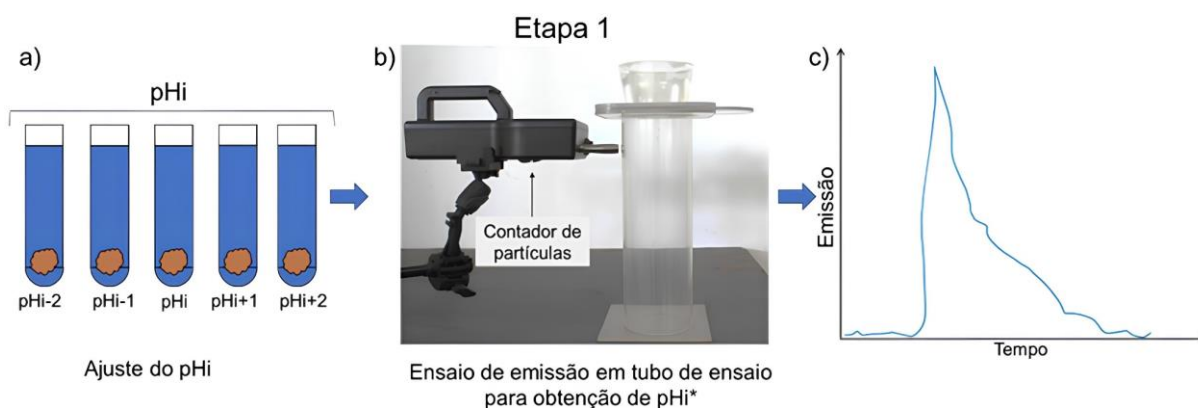
Figura 4.4 - Ensaio de emissão de poeira em tubo de ensaio na etapa 1.
