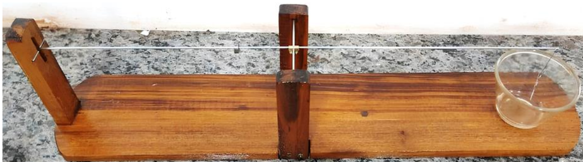
Figura 4.2 - Balança para medição de tensão superficial. Fonte: Adaptado de Reis et al. (2015).
