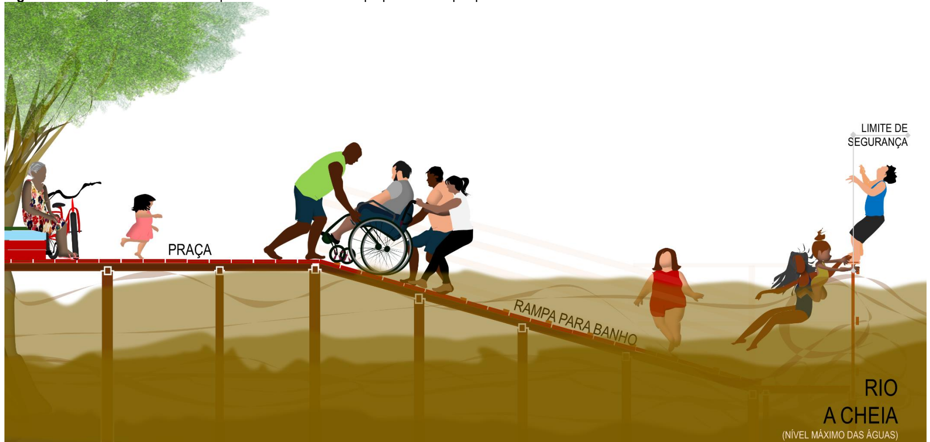
Figura 10 – Afuá, Pará: desenho esquemático do uso da rampa para banho por pessoas com mobilidade reduzida
