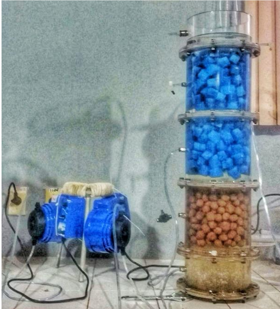
Figura 6 – Foto do reator anaeróbio de leito fixo montado.
