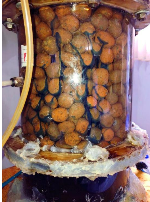
Figura 8 – Foto ilustrativa da primeira zona do RALF após injeção do traçador azul de bromofenol.
