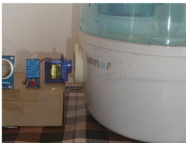
Figura 25 – Umidificador acoplado ao servomotor.
