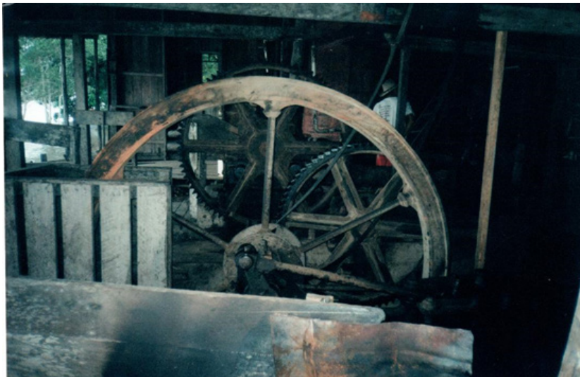
Figura 22. Moenda do Engenho Pacheco em 2012, ainda em funcionamento apenas com produção artesanal e bem reduzida, devido às condições de sucateamento encontradas nas máquinas
