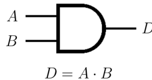
Figura 11. Símbolo e equação Booleana para a porta lógica AND.
