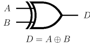
Figura 16. Símbolo e equação Booleana para a porta lógica XOR.
