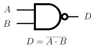
Figura 14. Símbolo e equação Booleana para a porta lógica NAND.
