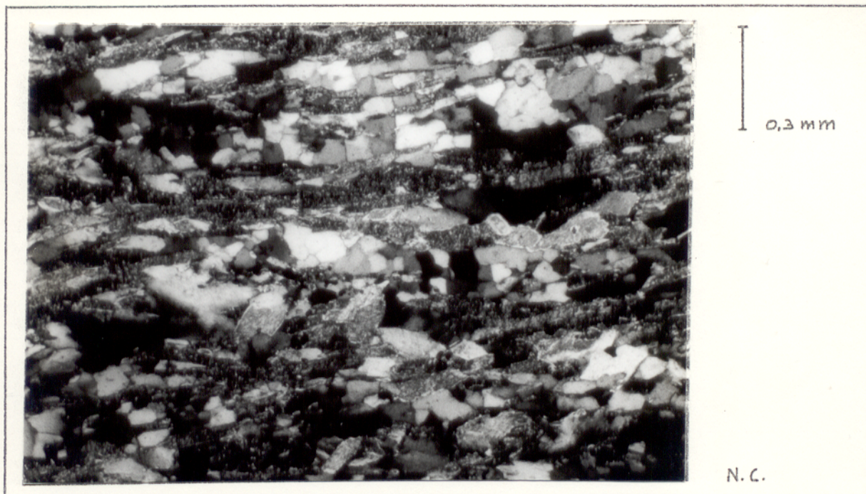
Figura 26 - Fotomicrografia de xisto do Domínio II, formado essencialmente por mica branca e quartzo. Aspecto da textura lepidoblástica heterogranular.
