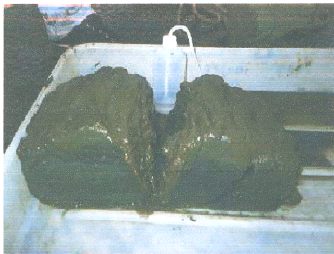
Figura 12: Amostra de sedimentos com a camada de cor castanha clara representa a camada oxidada da superfície dos sedimentos de fundo, enquanto que os sedimentos redutores sub-superficiais aparecem em cor castanha escura à preta.
