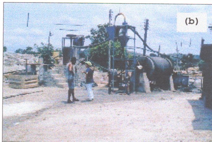
Figura 13 - (a) Esteira utilizada pelos garimpeiros para a separação do ouro; (b) pequena planta de tratamento dos rejeitos pelo método de flotação, para recuperação do ouro não liberado na primeira fase de beneficiamento do minério.
