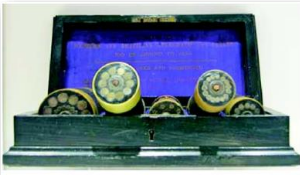
Figura 54 - Estojo contendo amostras de cabos submarinos utilizados pela Western and Brazilian Telegraph Company na linha Pernambuco-Pará.
