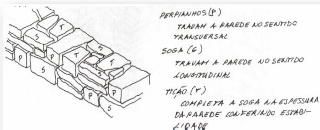
Figura 109 - Travamento dos paramentos das paredes de pedra
