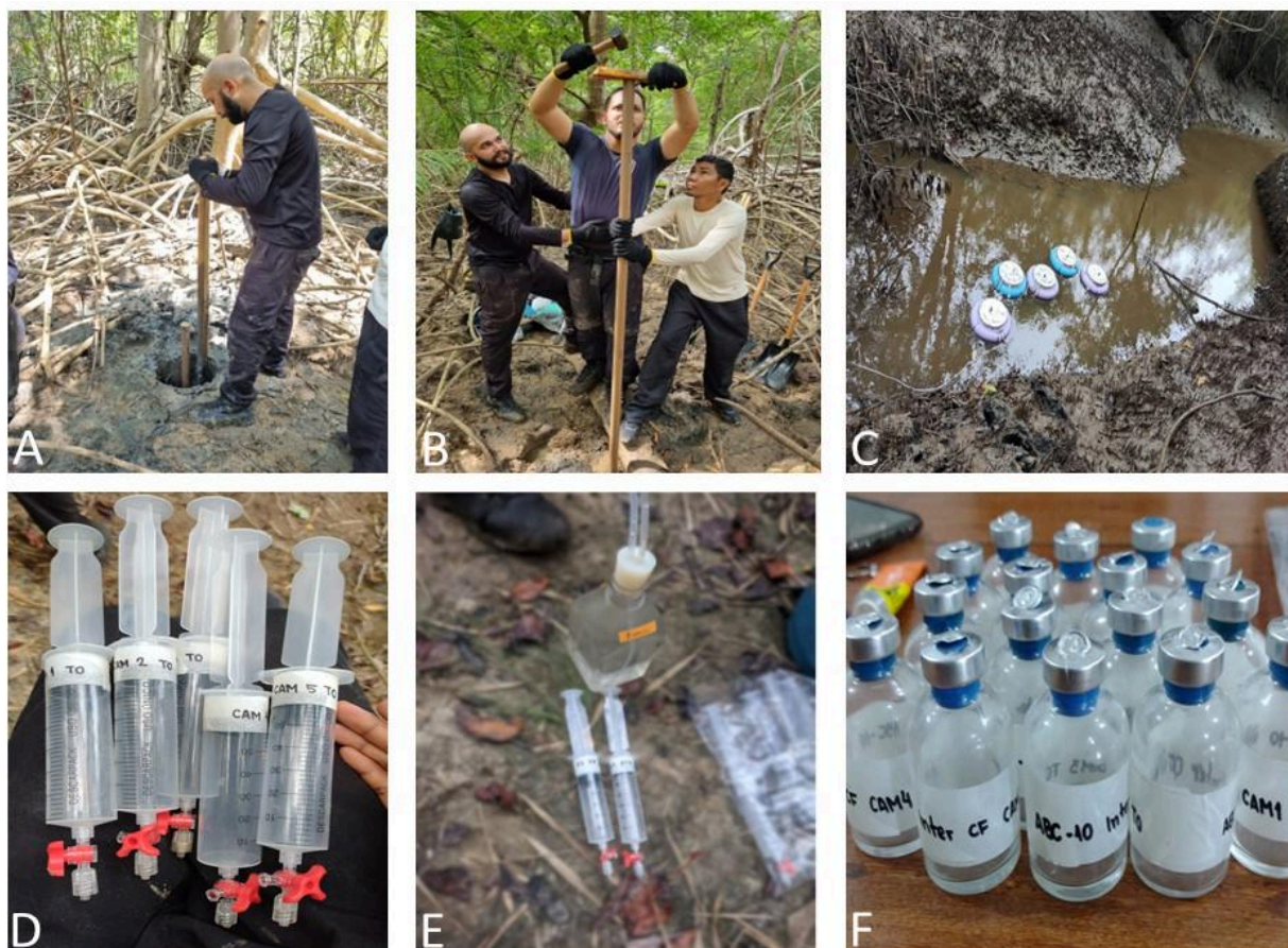
Figura 2: A) e B) Testemunhagem em área de manguezal. C) Medições de \text{CO}_2 e \text{CH}_4 com câmaras flutuantes. D) Coleta de amostra de gás de dentro das câmaras, com auxílio de seringas. E) Técnica de Headspace para coleta de gás dissolvido na água. F) Frascos de vidro preenchidos com amostras de gases.
