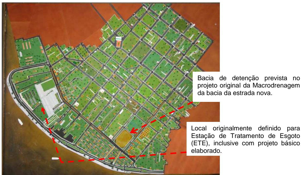
Figura 64 – Maquete física do projeto com a revisão de construção da bacia de detenção na sub-bacia 1. Fonte: Visita ao setor de projetos da construtora Andrade Gutierrez 41 em 2011.
