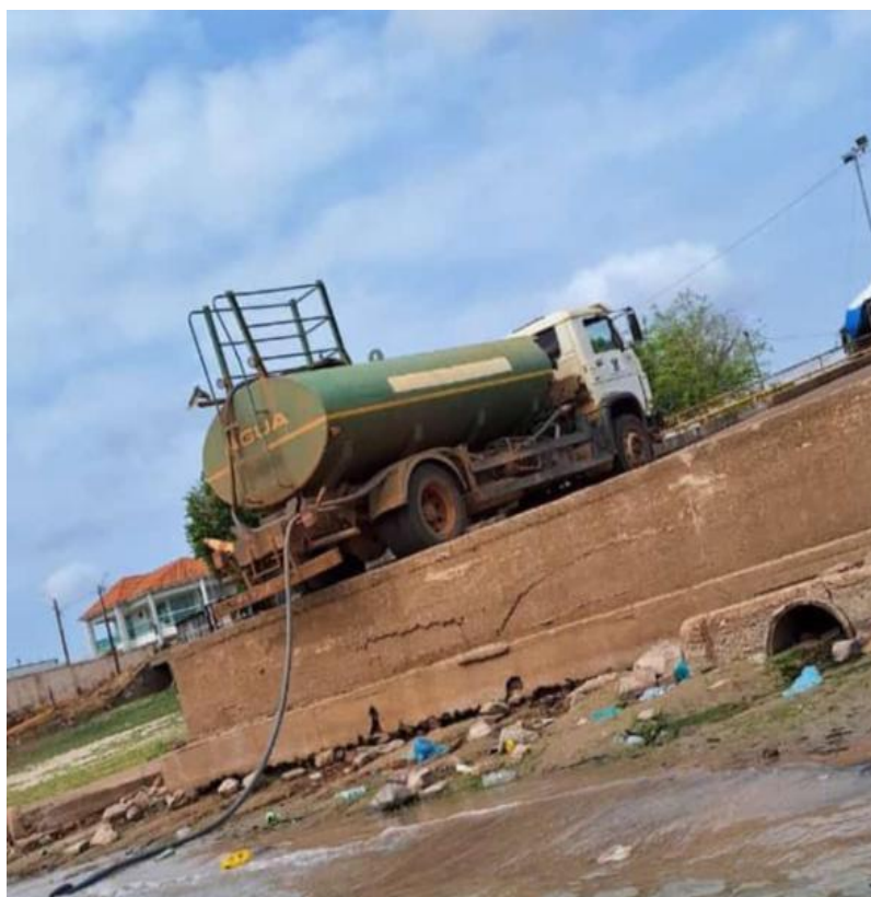
Figura 75: Captação de Água para abastecimento da população em local inapropriado, próximo ao Porto do Pepino.
