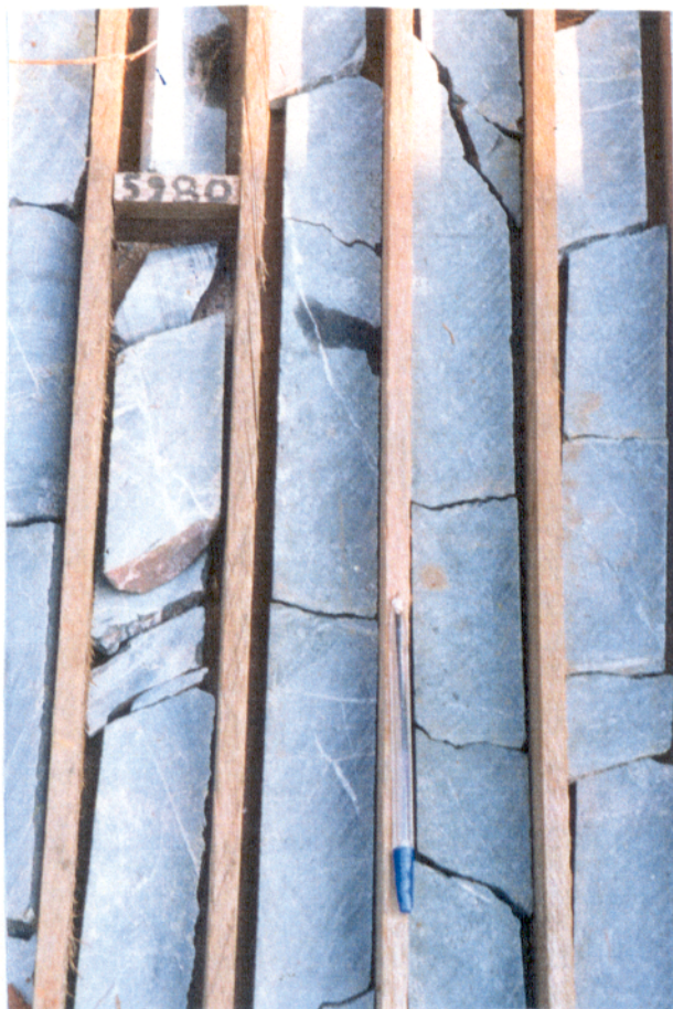
Figura 7 - Aspecto geral das rochas metavulcânicas básicas maciças do Alvo Borrachudo (FBO-06, intervalo: 58-62 m).
