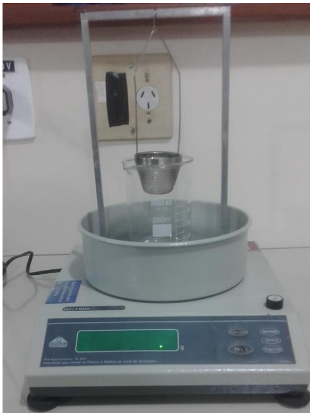
Figura 6- Aparato utilizado para se medir a massa dos corpos de prova imersos em água.
