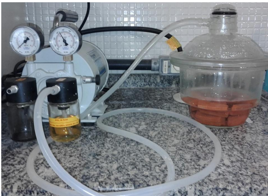
Figura 5- Aparato utilizado para obtenção do peso úmido dos corpos cerâmicos.
