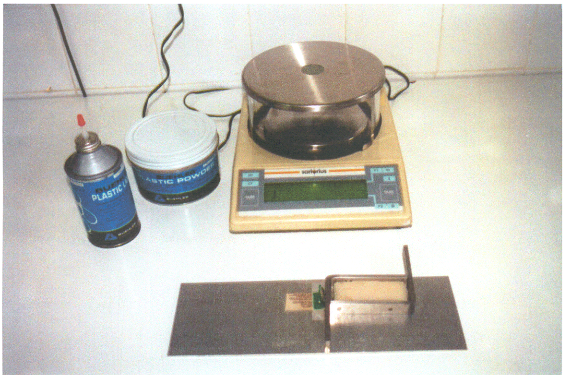
Figura 6 – Balança, molde e resina utilizados para o emblocamento das estruturas rígidas.
