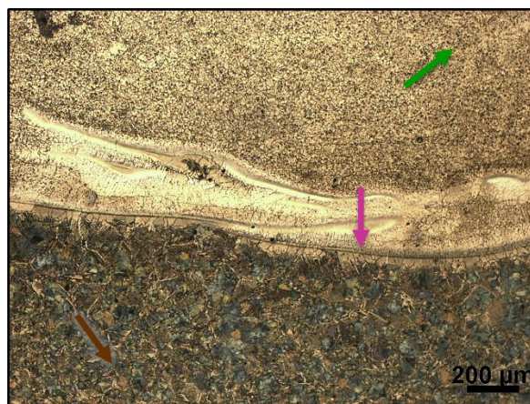
Figura 4.28 - Imagem óptica (ampliação de 50×) da seção transversal da interface ZTA/LF/ZF do cordão de solda NTF-U/CS. Setas marrom, magenta e verde escuro indicam, respectivamente, ZTA, LF e NTF-U/MS. Fonte: Autoria própria.
