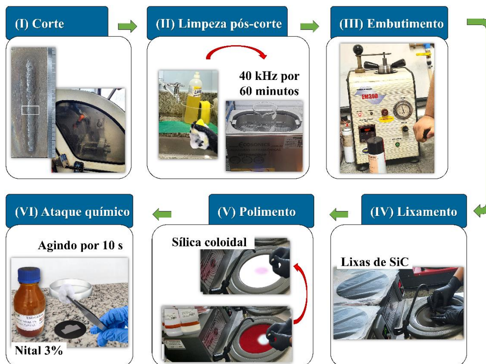
Figura 3.12 - Fluxograma da preparação metalográfica dos corpos de prova. Fonte: Autoria própria.
