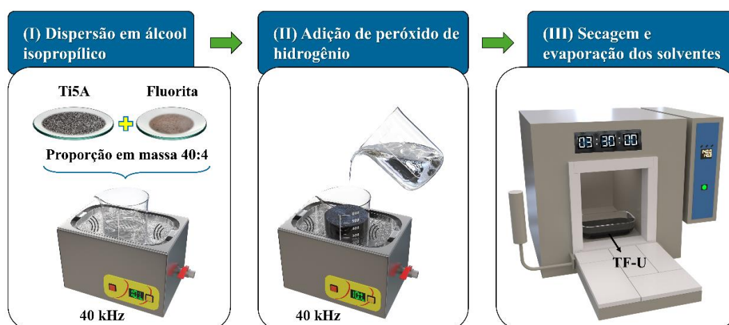
Figura 3.4 - Processamento do fluxo TF-U via ultrassonicação. Fonte: Autoria própria.
