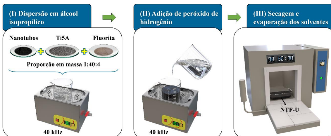
Figura 3.5 - Processamento do fluxo NTF-U via ultrassonicação. Fonte: Autoria própria.
