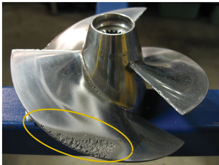
Figura 10 – Erosão por cavitação em hélice após operação prolongada. Fonte: Sun et al. (2022).
