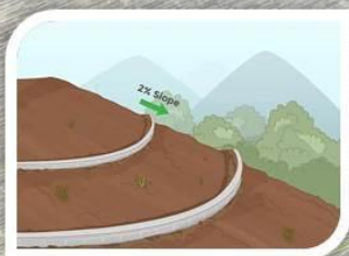
A- Paredes de contenção
