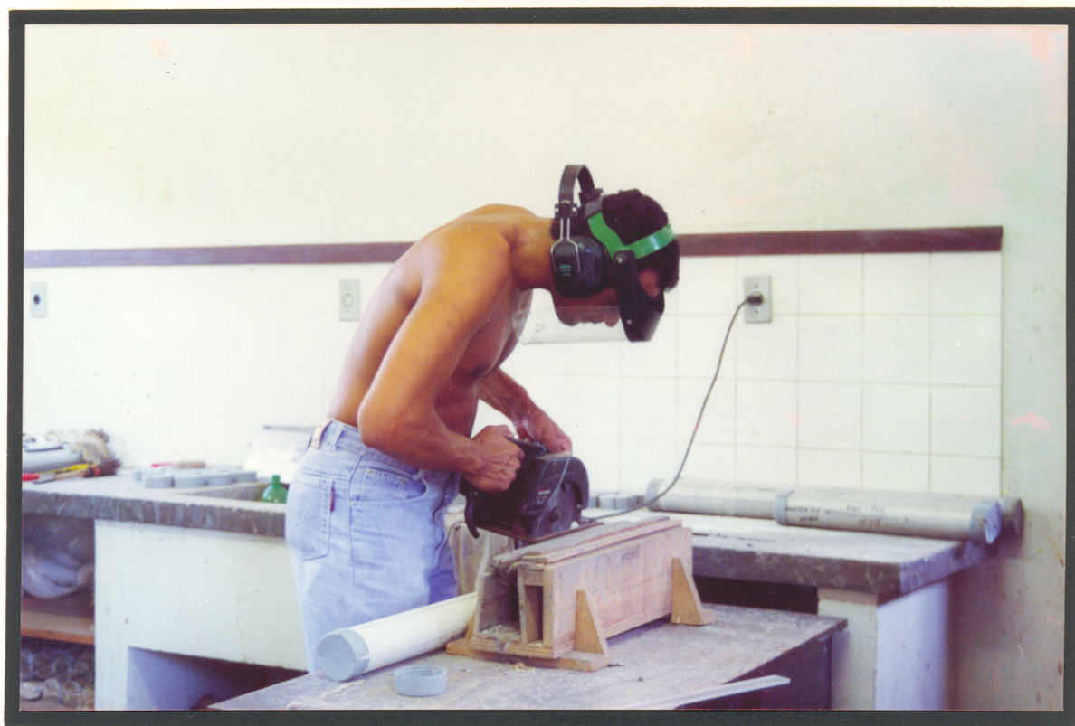
Figura 2.3: Etapa laboratorial, referente ao corte longitudinal dos tetestemunhos.
