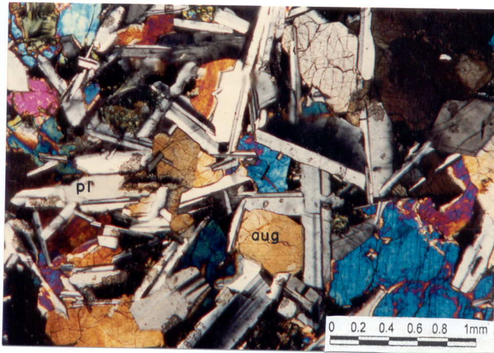
Figura 43: Fotomicrografia da textura ofítica em augita-diabásio, formada por ripas de plagioclásio (pl) e cristais tabulares de augita (aug) (EM-218; 5X; NX).
