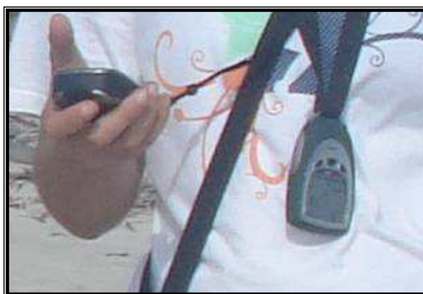
Figura 4.10 - GPS e altímetro em uso (A) GPS etrex Vista e (B) Altímetro Suunto Digital Escape 203
