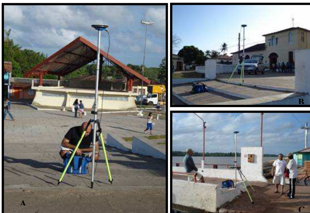
Figura 4.8 - DGPS em uso na (A) e (B) Praça da cidade de Carutapera –MA;(C) Porto do Gurupí , DGPS em cima do marco geodésico na cidade de Boa Vista do Gurupi.
