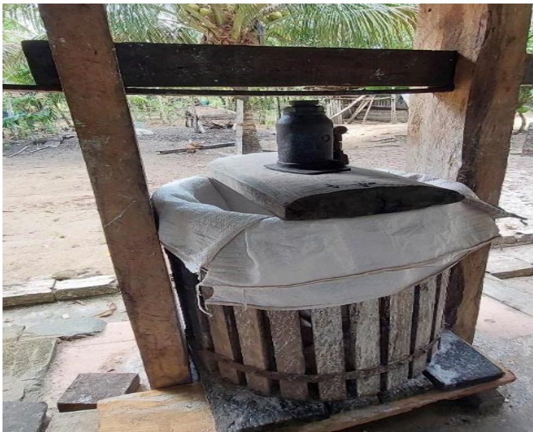
Figura 47-Macaco hidráulico em prensa de casa de farinha.
