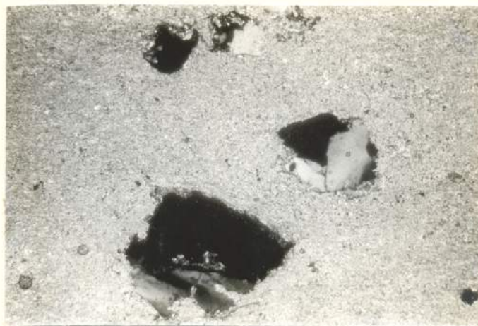
Figura 5.9 - Leucogranitóides. (A) Textura inequigranular seriada; observam-se monocristais de quartzo, K-feldspato e plagioclásio sódico (An12) intergranular. (Seção delgada 250.) (B) Transformação quase total do leucogranitóide em zona de cisalhamento, mostrando ainda relictos de porfiroclastos de quartzo numa matriz micácea (fundo cinza claro). (Nicóis X, seção delgada 53B.)
