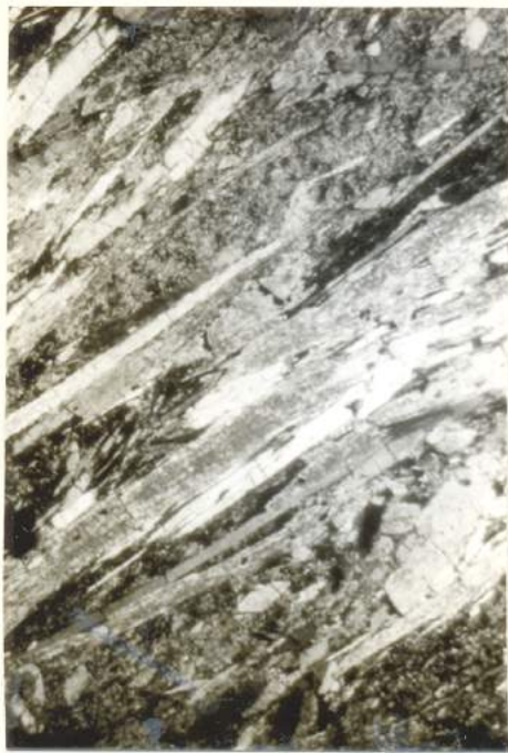
Figura 5.1 - Cristais de tremolita colunar ou acicular, em arranjo paralelo, numa matriz fina (talco), interpretados como relíquias de texturas "spinfex" recristalizadas. (Nicolóis X, seção delgada 516.)
