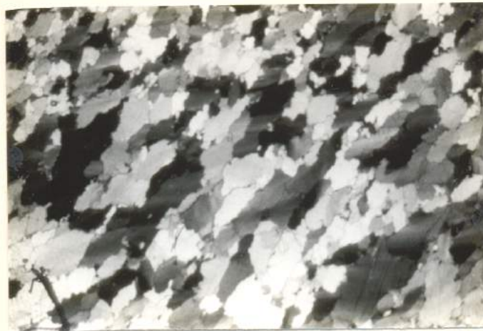
Figura 5.10 - Veios de quartzo deformados. (A) Quartzo recristalizado, reorientado, estirado na foliação milonítica penetrativa. (Nicóis X, seção delgada 4C.) (B) Textura de crescimento exagerado de grãos, modificando a fábrica milonítica prévia. (Nicóis X, seção delgada 137C.)
