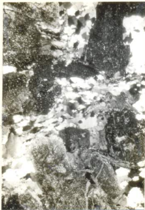
Figura 5.7 - Granodiorito Rio Maria. (A) Textura equigranular hipidiomórfica, com monocristais de quartzo. (B) Textura inequigranular, marcada por quartzo recristalizado, policristalino. (C) Esboço a partir de (B). (Nicóis cruzados, seção delgada 44B.)
