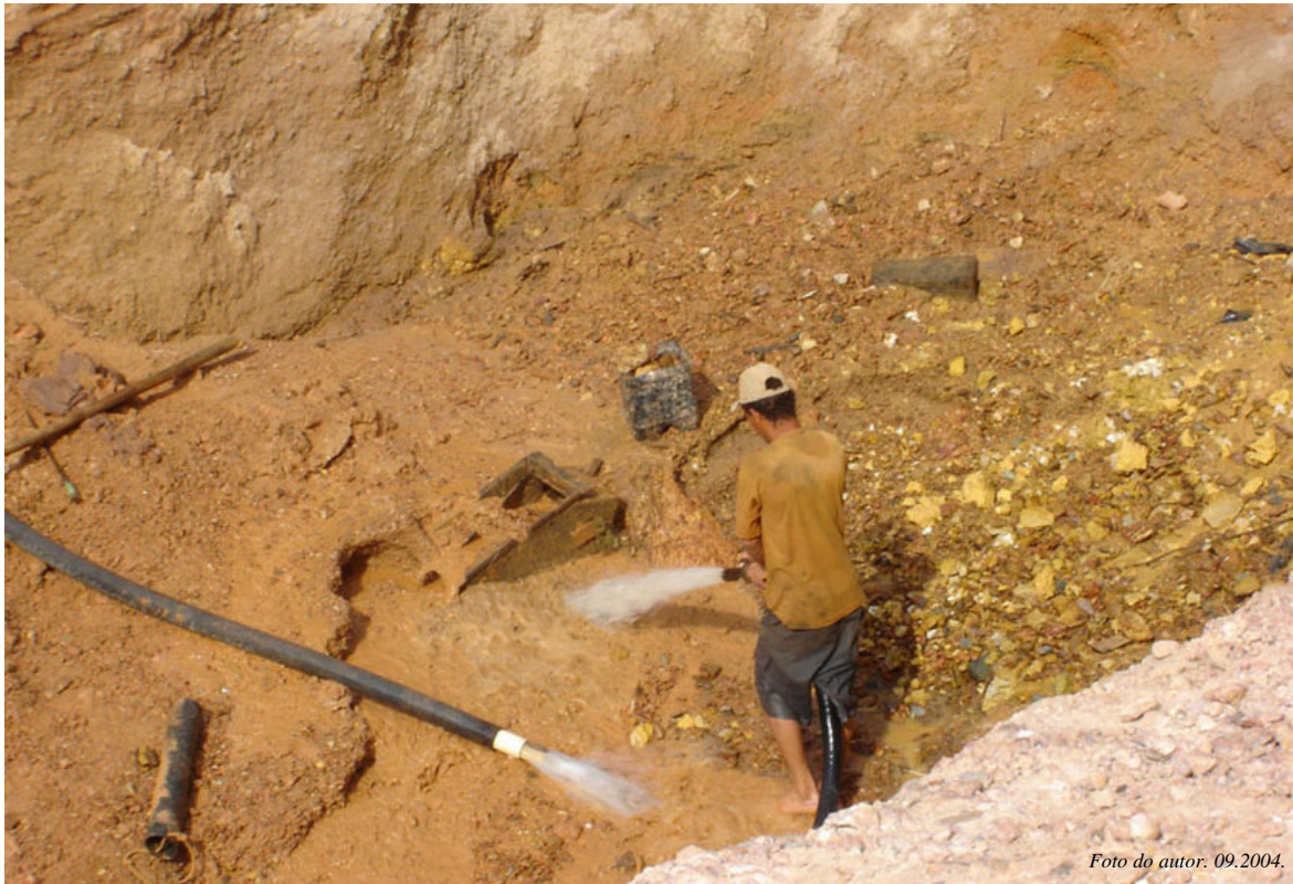
Figura 02 – Mineração a céu-aberto, com o uso de “bico-jato” para o desmonte hidráulico do material.
