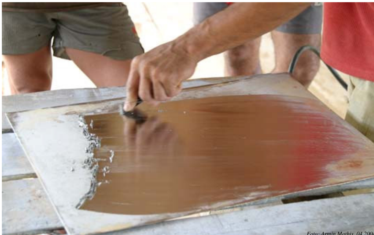
Figura 14 – Raspagem de placa após a queima com maçarico.
