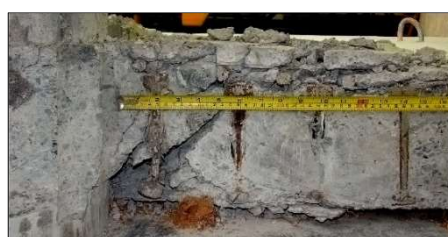
b) Ruptura dentro da região das armaduras ( V_{R,cs} ) (Ferreira, 2010)
