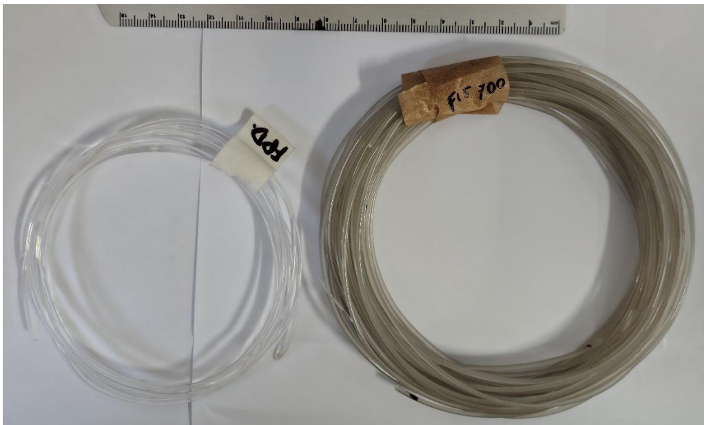
Figura 15 – Filamentos produzidos. Filamentos na esquerda: FPLA; Filamento na direita: F1,5% H700.
