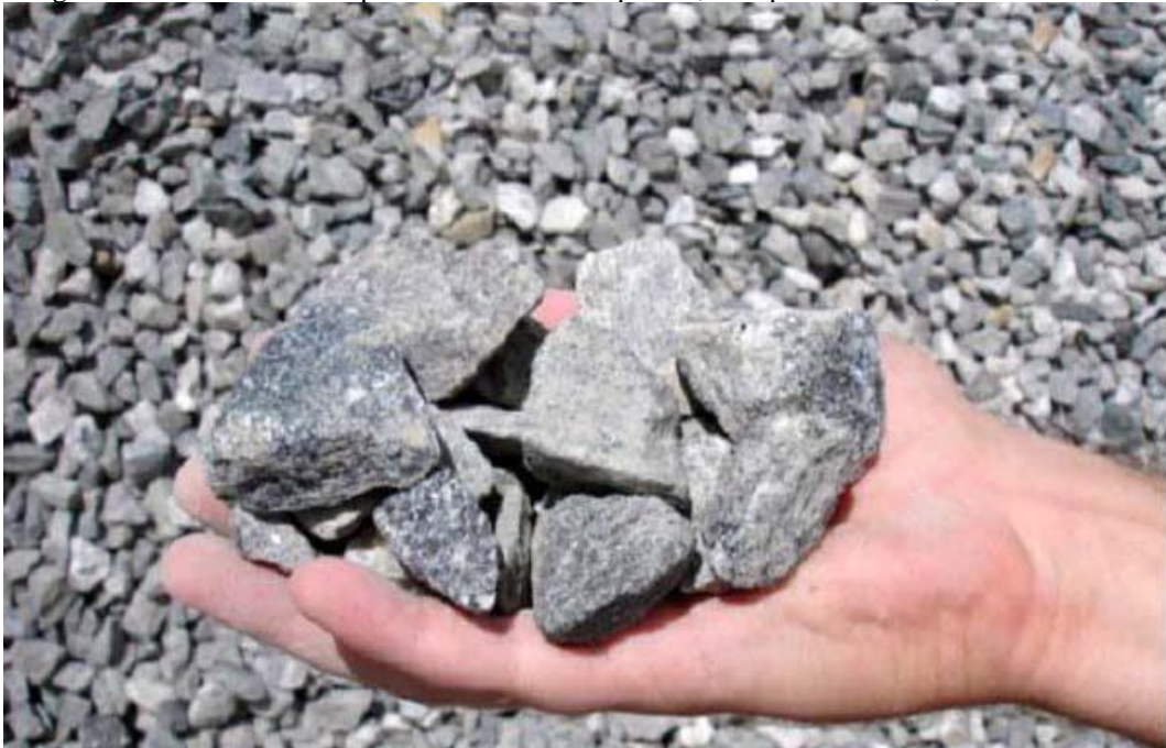
Figura 1 – Granito formado por minerais como o quartzo, feldspatos e biotita, na forma de brita.
