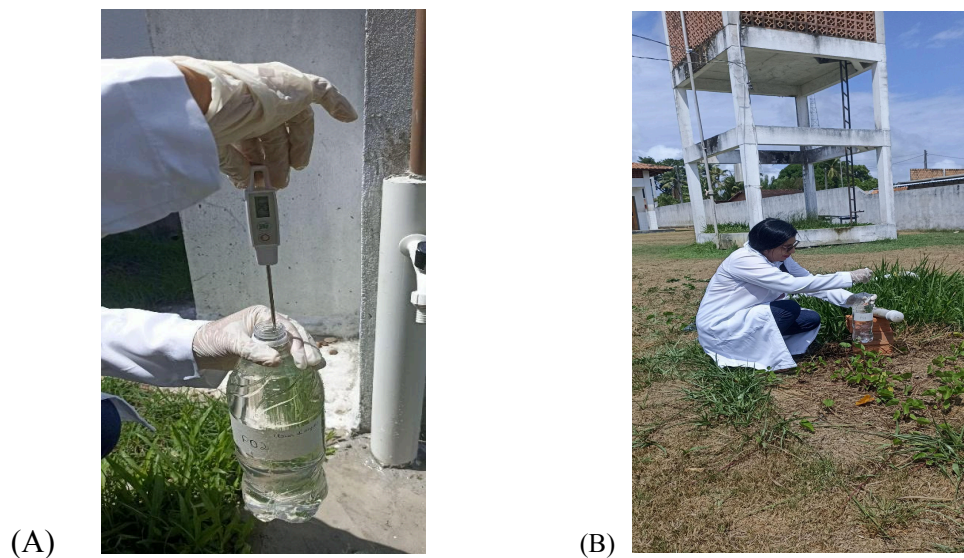
Figura 8 - Coleta e aferição da temperatura da amostra in loco .
