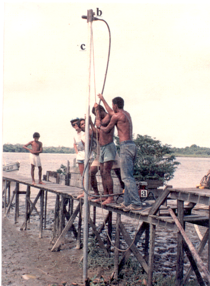
Figura 2.2 - Coleta de testemunhos utilizando-se o sistema Vibracore, que consiste de um motor (a), que emite vibrações a um cabeçote de aço (b), acoplado a um tubo de alumínio (c).
