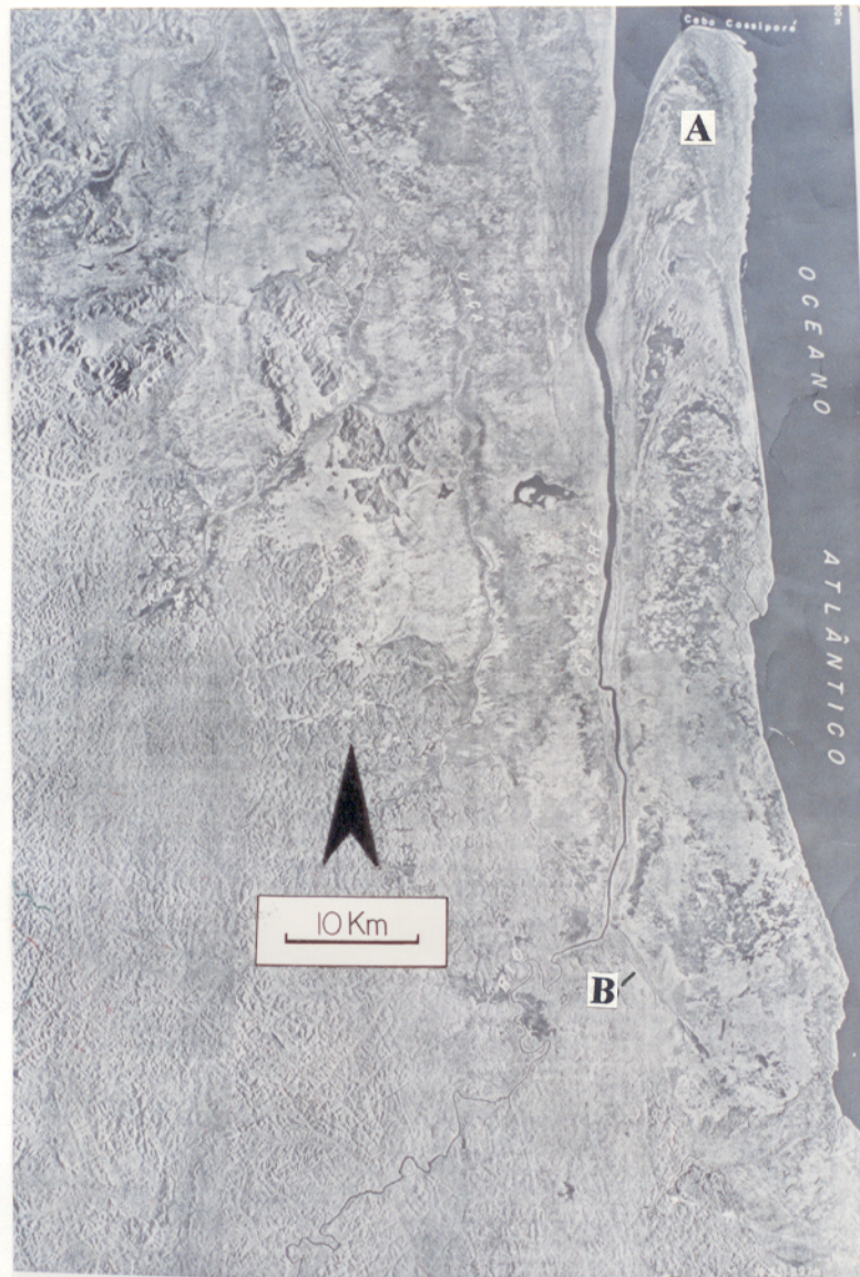
Figura 3.3 - Feições morfológicas que caracterizam a porção norte da Planície Costeira do Amapá, observadas em imagem de radar (folha NA.22-V-B), na escala 1:250.000: (A) planície lamosa do Cabo Cassiporé e (B) cordões de cheniers .
