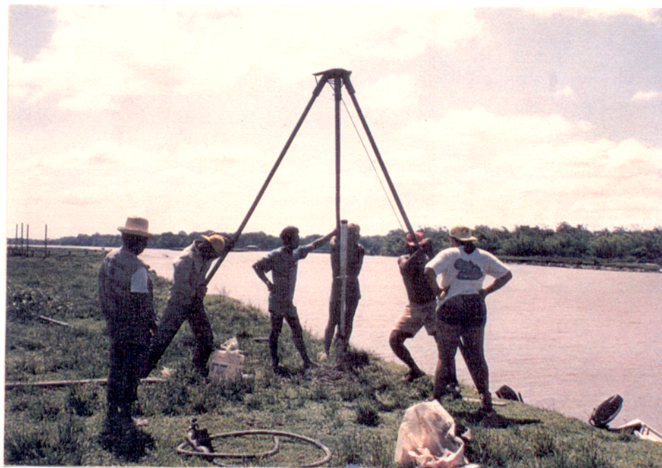
Figura 2.3 - Retirada do testemunho utilizando-se um sistema de tripé, constituído por torre, roldana, cabos de aço, catraca e manivela.
