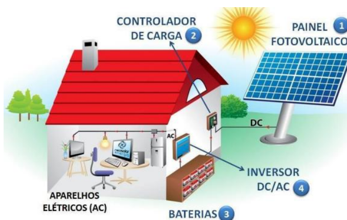
Figura 2.3 – Funcionamento dos sistemas Off-Grid.
