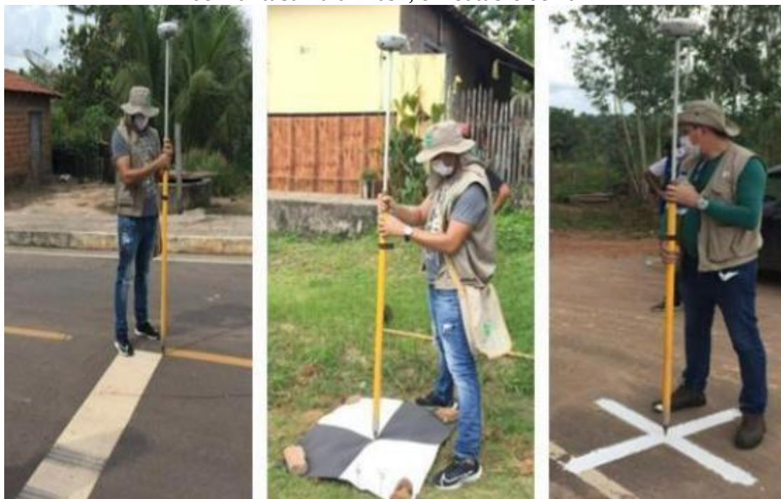
Figura 12 - Coleta de pontos de controle com RTK no bairro União, município de Marituba-Pará-Brasil, em outubro de 2022
