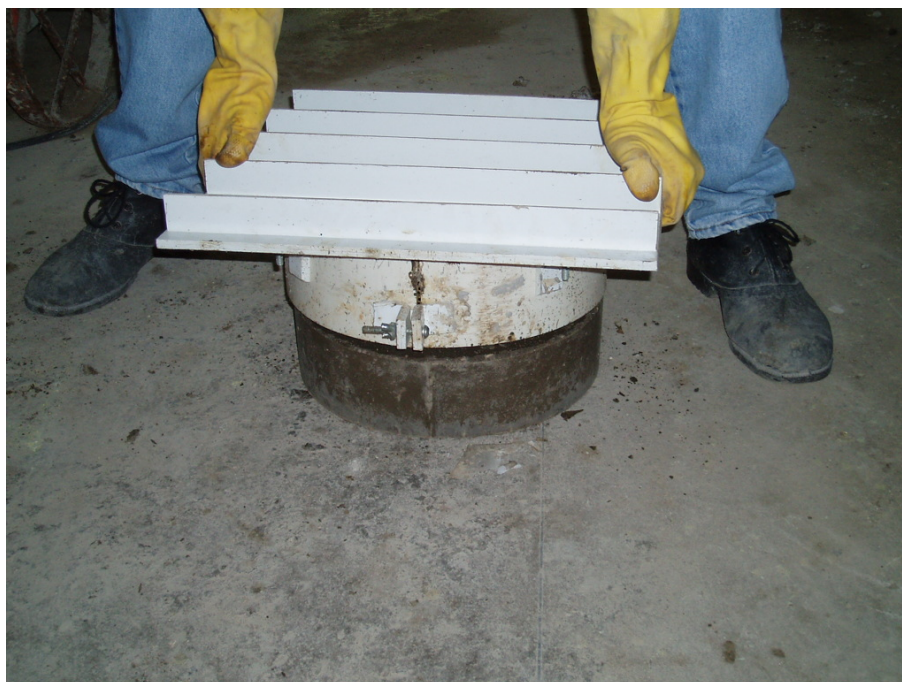
figura 22 – Desmolgagem dos cp's do substrato após 20 horas de aplicado, destacando o uso e fôrmas de PVC próprias para a confecção destes cp's (FOTO: José Rodrigo Santana Pinho).
