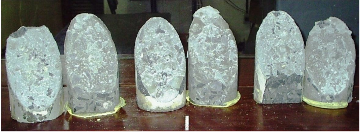
figura 34 – Ruptura na ponte de aderência dos cp's colados com adesivo epóxi para superfícies úmidas, aos 28 dias de idade (FOTO: José Rodrigo Santana Pinho).
