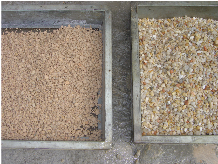
figura 10 – Seixo utilizado e passante na peneira de abertura de malha quadrada de 9,5 mm antes do processo de lavagem (à esquerda) e após o processo de lavagem (à direita) (FOTO: José Rodrigo Santana Pinho).
