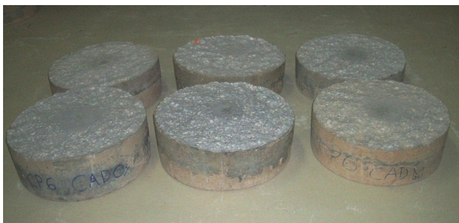
figura 53 – Espécimes de 300x100mm de concretos que mais sofreram mais desgaste ao final do ensaio. Acima: corpos-de-prova ensaiados aos 3 dias; abaixo: aos 28; da esquerda para a direita: CAD 0%, CAD S10% e CAD M10% (FOTO: José Rodrigo Santana Pinho).
