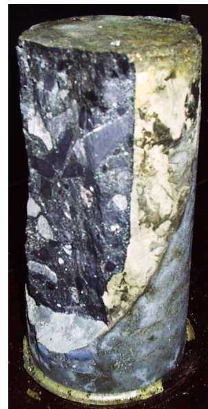
figura 35 – Vistas do cp 05, colado com pasta cimentícia com adição de sílica ativa, aos 28 dias, denotando ruptura no concreto velho e no final da ponte de aderência. Apesar deste tipo de ruptura, o referido cp não foi considerado na análise dos dados devido à sua baixa resistência quando comparado aos demais (FOTO: José Rodrigo Santana Pinho).
