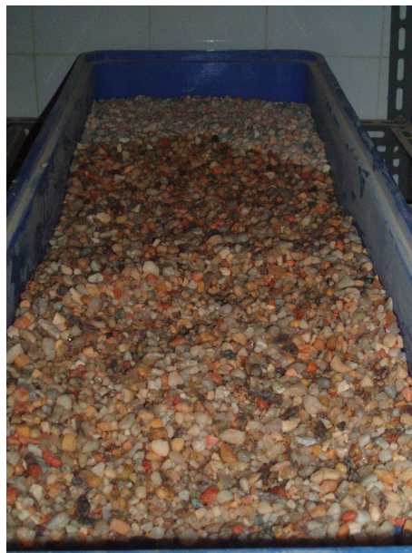
figura 11 – Agregado graúdo lavado e peneirado, secando ao ar, abrigado de intempéries (FOTO: José Rodrigo Santana Pinho).
