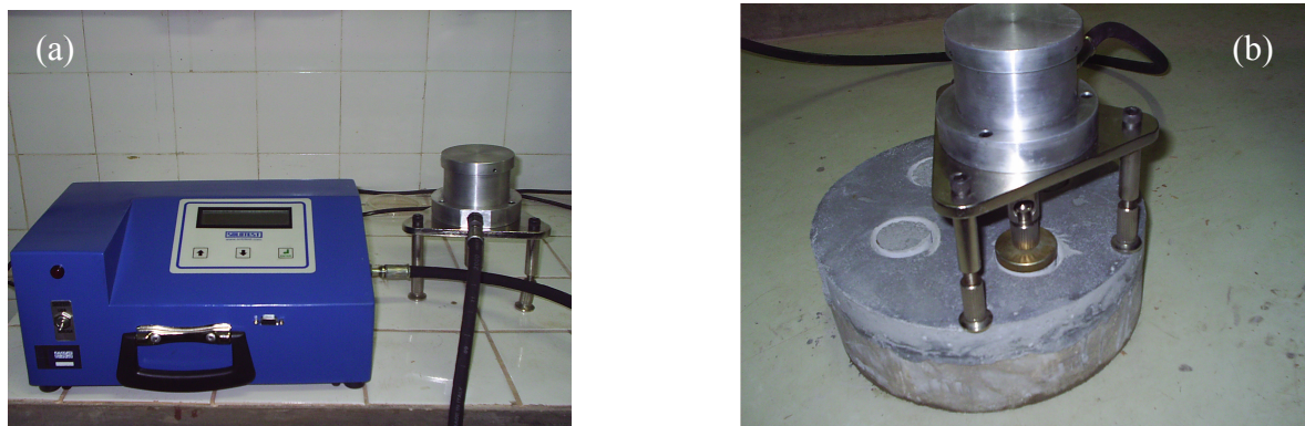
figura 3 – (a) aparelho de arrancamento com controle taxa automático; (b) execução do ensaio (FOTO: José Rodrigo Santana Pinho).
