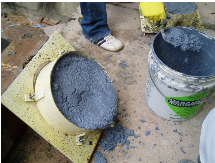
figura 48 – Aplicação da AE em substrato úmido e inclinado, na tentativa de simular as condições de aplicação da argamassa em superfícies verticais. Nota-se que a AE escorre na superfície do cp de abrasão, podendo inviabilizar o seu uso em superfícies não-horizontais (FOTO: José Rodrigo Santana Pinho).
