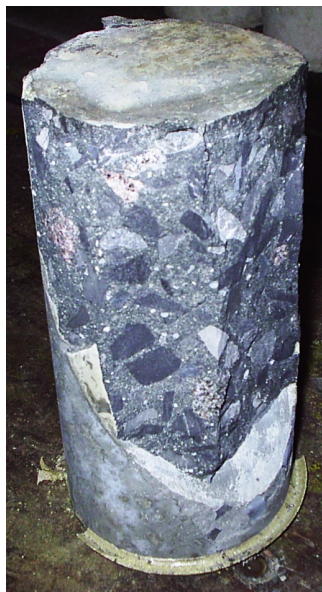
figura 35 – Vistas do cp 05, colado com pasta cimentícia com adição de sílica ativa, aos 28 dias, denotando ruptura no concreto velho e no final da ponte de aderência. Apesar deste tipo de ruptura, o referido cp não foi considerado na análise dos dados devido à sua baixa resistência quando comparado aos demais (FOTO: José Rodrigo Santana Pinho).
