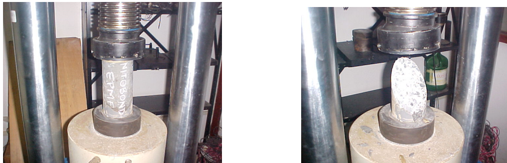
figura 38 – Ruptura usual de cp colado com adesivo epóxi para superfícies secas, aos 28 dias (FOTO: José Rodrigo Santana Pinho).
