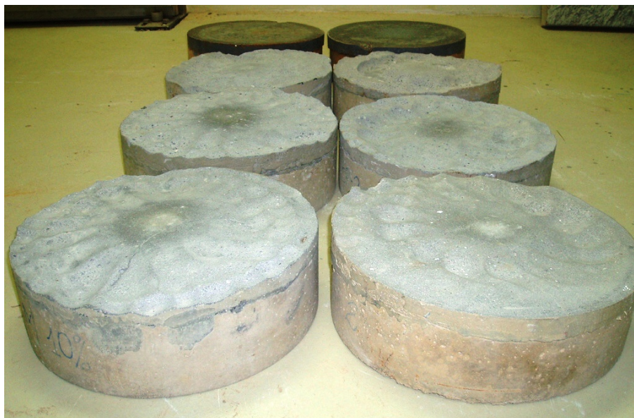
figura 52 – Espécimes de 300x100mm de argamassas que mais sofreram mais desgaste ao final do ensaio: à esquerda, os cp's ensaiados aos 28 dias e a direita aos 3; de cima para baixo: AE, AAD 0%; AAD S10% e AAD M10% (FOTO: José Rodrigo Santana Pinho).
