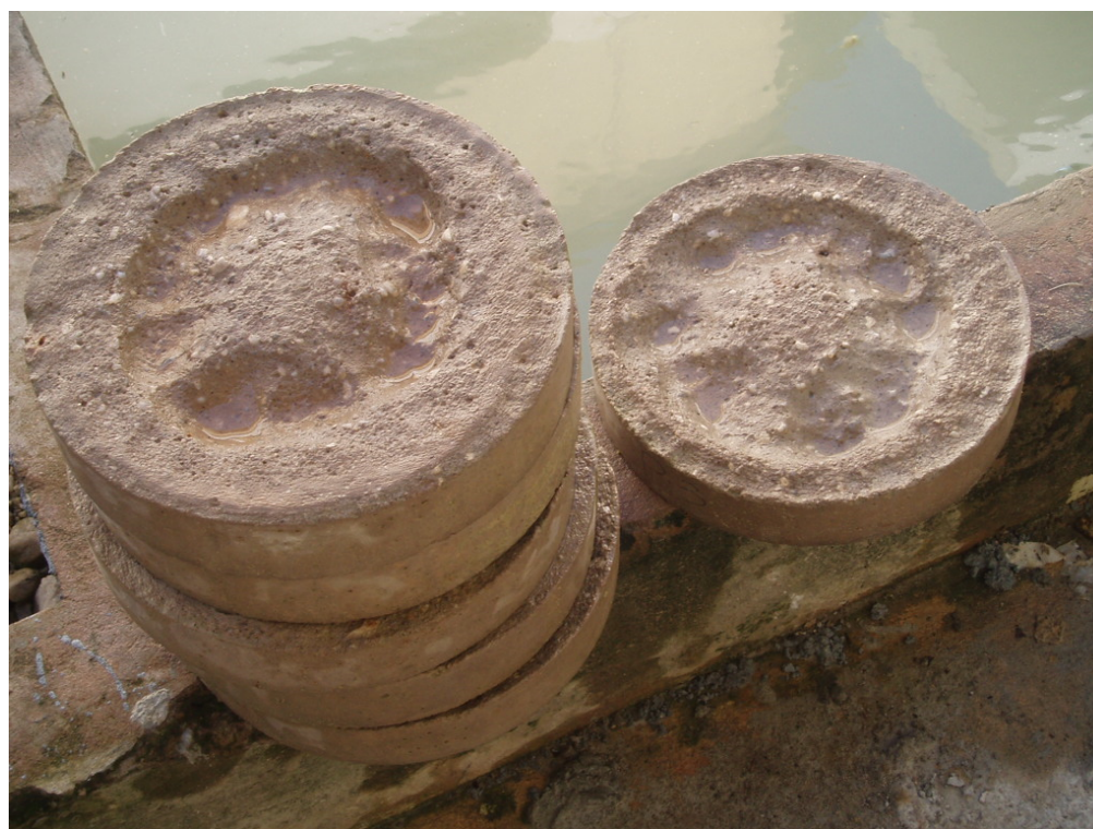
figura 23 – Aspectos da superfície dos cp's do concreto de referência (substrato), após 20 horas de ensaio na máquina de abrasão ASTM C 1138 (FOTO: José Rodrigo Santana Pinho).
