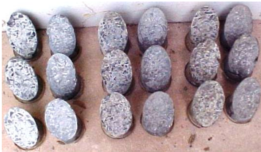
figura 33 – Ruptura dos cp's colados com materiais “industrializados”, aos 3 dias de idade, na junta diagonal de colagem (FOTO: José Rodrigo Santana Pinho).
