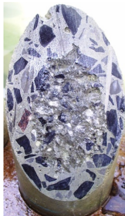
figura 18 – Aspecto da superfície dos cp's após apicoamento e limpeza da superfície diagonal (FOTO: José Rodrigo Santana Pinho).
