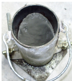
figura 19 – Cp na fôrma, após a aplicação do adesivo, prestes a ser complementado com concreto de alta resistência (FOTO: José Rodrigo Santana Pinho).
