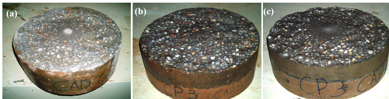
figura 46 – Aspecto final (após 72 horas de ensaio) dos espécimes de concreto de reparo: (a) CAD 0%; (b) CAD S10%; (c) CAD M10%. Não há diferença estatística entre a média destes materiais (FOTO: José Rodrigo Santana Pinho).
