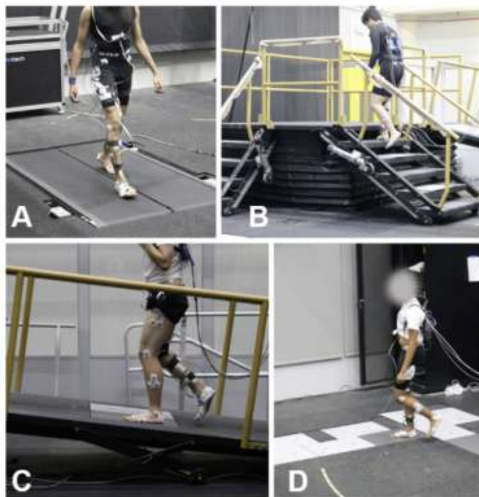
Figura 4 – Montagens experimentais com plataformas de força embutidas em esteiras, escadas, rampas e pisos.
