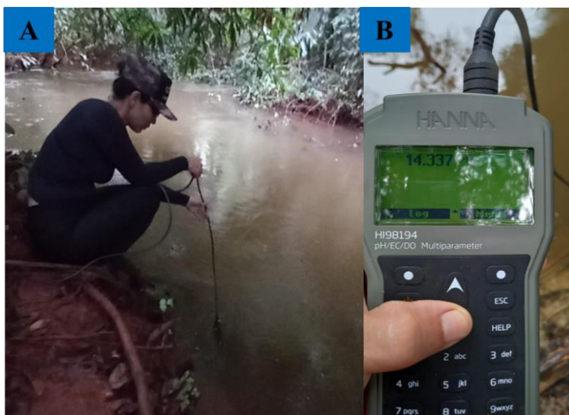
Figura 13- Coleta de água para análise de metal (A); Medidor utilizado para a coleta e análise dos parâmetros físico-químicos da água(B) (Fonte: OLIVEIRA,2022).
