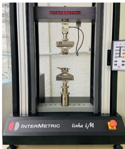
Figura 11- Máquina Universal INTERMETRIC utilizada no ensaio de tração
