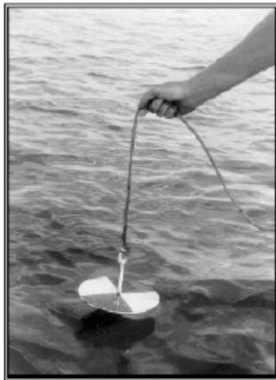
Figura 8 - Disco de Secchi para obtenção ótica da transparência sendo mergulhado.
