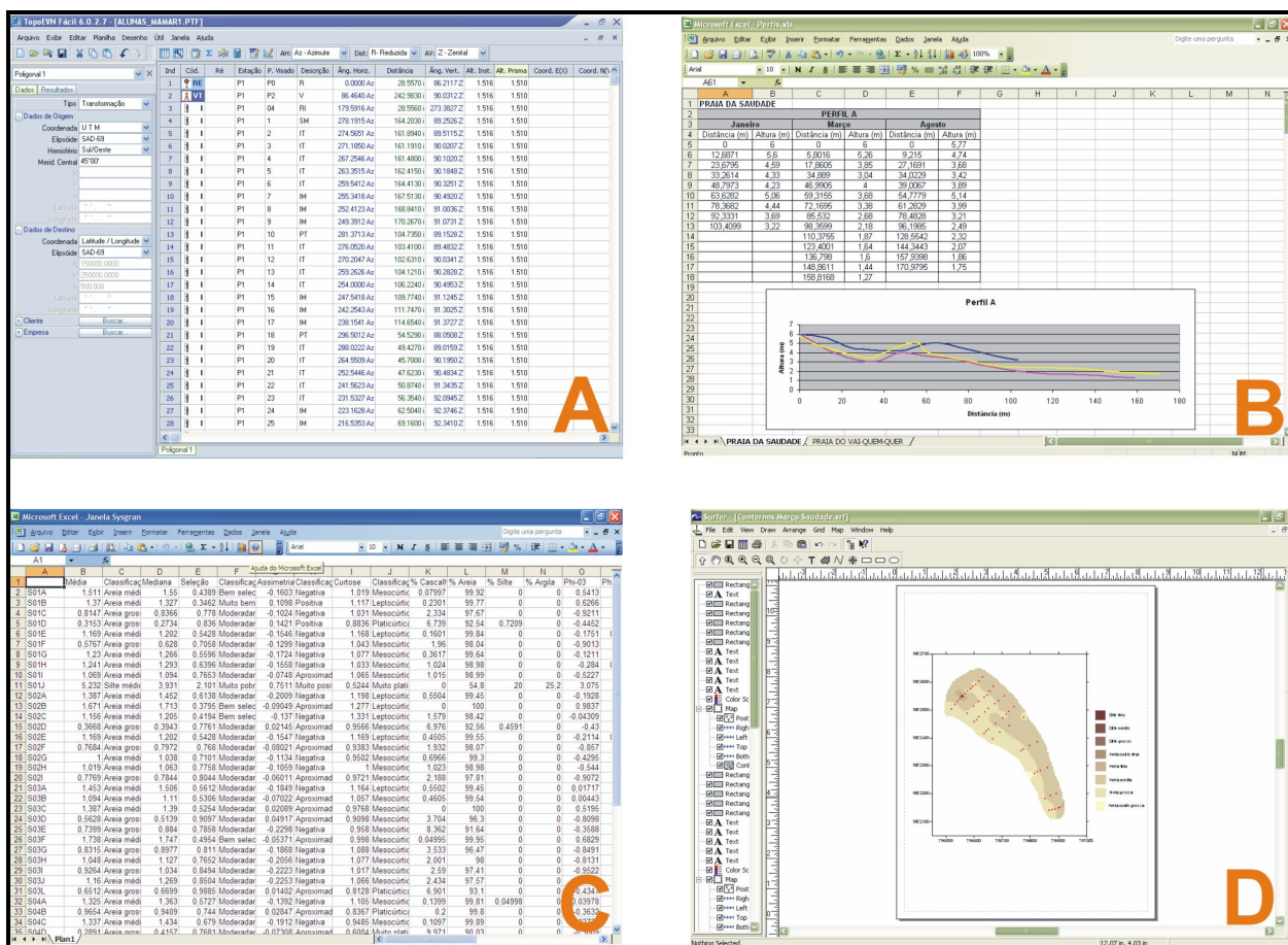
Figura 7: Telas ativas dos softwares TopoEVN onde foram descarregados os dados da Estação Total, Excel para sobreposição dos perfis topográficos, SysGran utilizado para obter os parâmetros estatísticos e Surfer 8 para elaboração dos mapas sedimentológicos.
