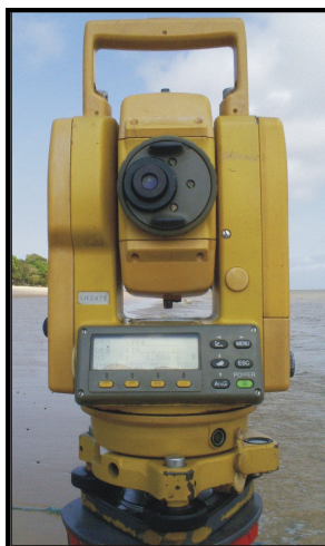
Figura 2: Estação Total da Marca Topcon e Modelo GTS 212 utilizada para o levantamento dos perfis praias.
