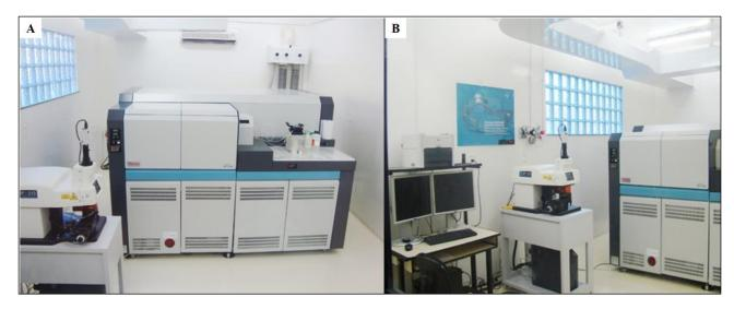
**Figura 8** - Vista do espectrômetro de massa ICP-MS-MC Thermo-Finnigan, modelo *Neptune* (A) e do sistema de *laser ablation* (LA) CETAC, modelo LSX-213 G2, à esquerda (B), Laboratório Pará-Iso/UFPA.
