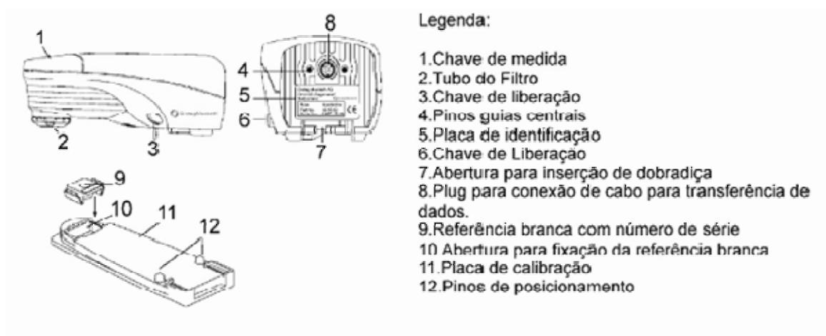
Figura 15 – Elementos funcionais do espectrofotômetro para sólidos
