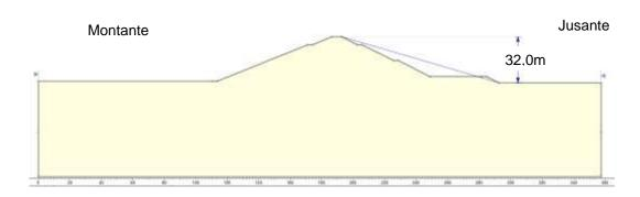
Figura 49: Seção Principal da Barragem.
