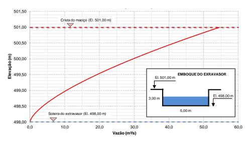
Figura 45: Extravasor (Curva de descarga)
