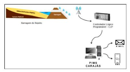
Figura 62: Sistema de pré-alarme em função dos níveis de controle
