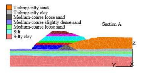
Figura 31: Modelagem no MIDAS/GTS
