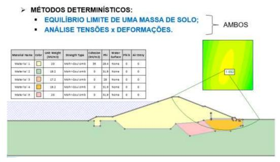
Figura 37: Exemplo de análise de estabilidade no software SLIDE.
