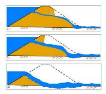
Figura 36: Modelo de Ruptura por piping. Fonte: (LARA, 2016)
