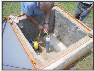
Figura 19: Leitura do Piezômetro Tubo Aberto Fonte: (MACHADO, 2007)
