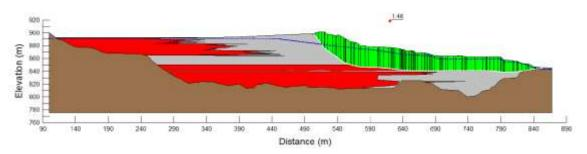
Figura 68 – Análise Não Drenada - Ombreira esquerda – nov. /2015 Fonte: (Morgenstern et al., 2016)
