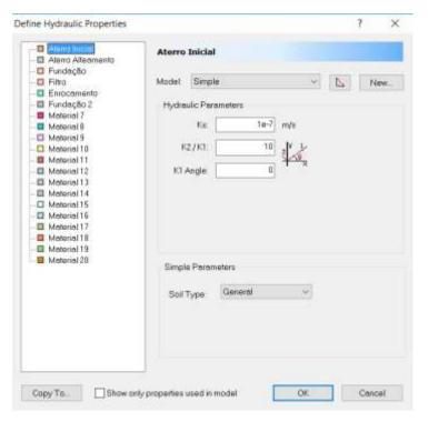
Figura 53: Inserção dos parâmetros de permeabilidade e critérios para análise de percolação no software Slide 6.0
