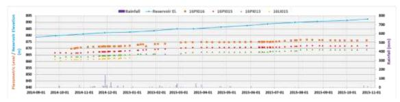
Figura 65 – Dados de piezômetros da ombreira esquerda Fonte: (Morgenstern et al., 2016)
