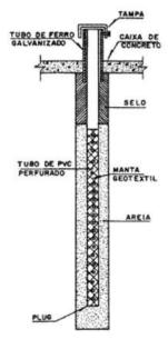
Figura 17: Medidor de Nível de Água Fonte: (MACHADO, 2007)
