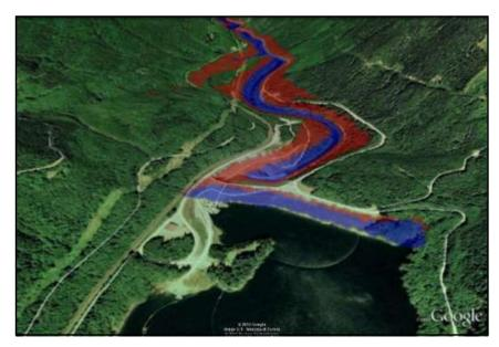
Figura 27: Simulação de DAM BREAK Fonte: (DNPM, 2017)
