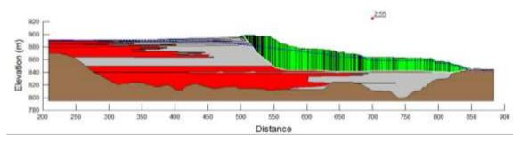
Figura 67 – Análise Drenada – Ombreira esquerda – nov. /2015 Fonte: (Morgenstern et al., 2016)
