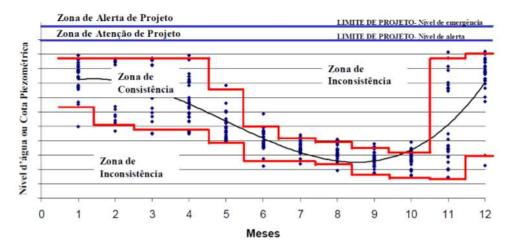
Figura 39: Modelo de análise para piezômetro.
