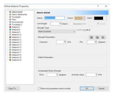
Figura 52: Inserção dos parâmetros de resistência e critérios para análise de estabilidade no software Slide 6.0
