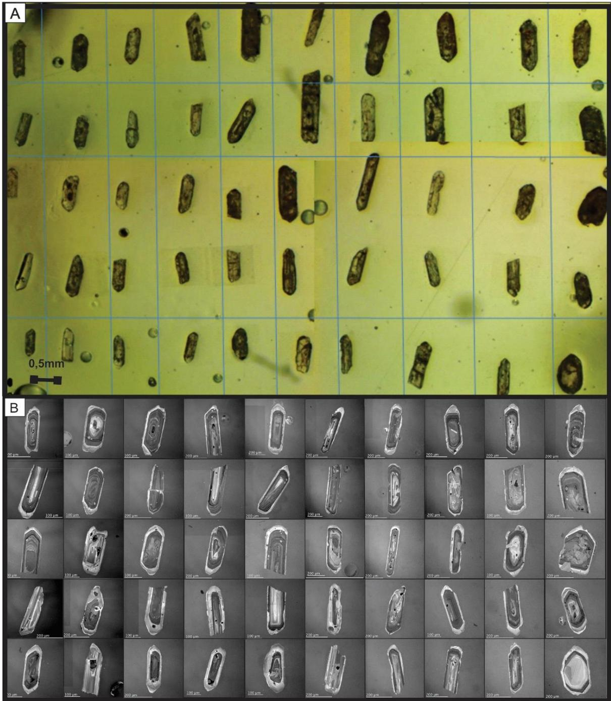
Figura 1.4- Cristais de zircão da amostra P2: A) Montagem e organização dos cristais de zircão em resina epóxi (*mount*); B) Imagem de catodoluminescência dos cristais de zircão.
