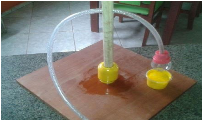
Imagem 06: Destilador caseiro, protótipo inicial Fonte: Autora da pesquisa
