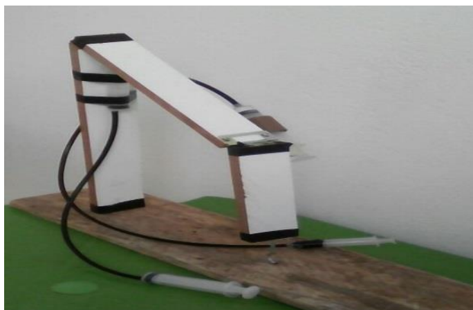
Imagem 12: Experimento Braço Hidráulico. Fonte: Autora da pesquisa
